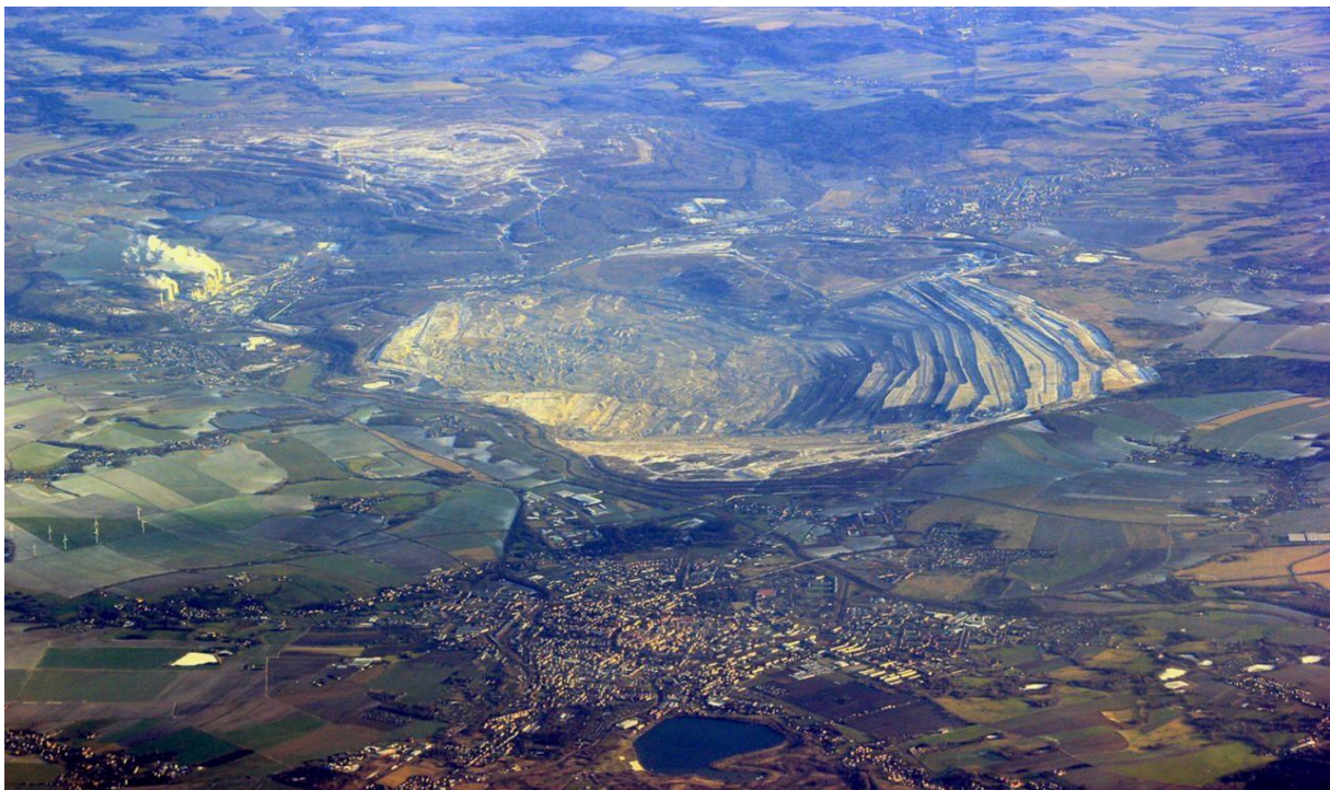
Abbildung 3 – Blick von West nach Ost. Vordergrund: Olbersdorfer See und Kreisstadt Zittau mit Grenzfluss Neiße; Bildmitte: Tagebau Turów, mit großflächig abgerutschter Innenkippe (links) und voranschreitendem Abbau (rechts). Hintergrund rechts: Stadt Bogatynia, links: Abraum-Außenkippe und Aschenhalde sowie Kraftwerk Turów (links davor).
