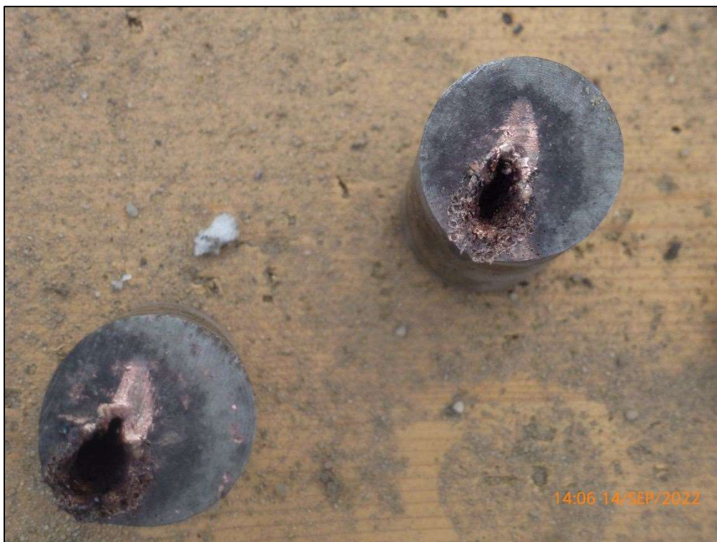
Abb.1: Typischer Materialantrag von Kupferlegierung an der Eintrittsstelle von Punktladungen
