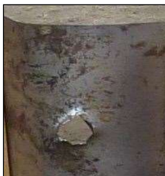
Abb. 3: Deformiertes Blech aus Anspannung. Ladung in größerem Abstand zum Blech
