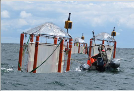
Mesoskosmen: fast zwei Tonnen schwere „Türme“ (Schwimmkörper und einem 17 Meter langen Sack), acht Meter hoch, Volumen: 47.000 Liter; © IFM Geomar
