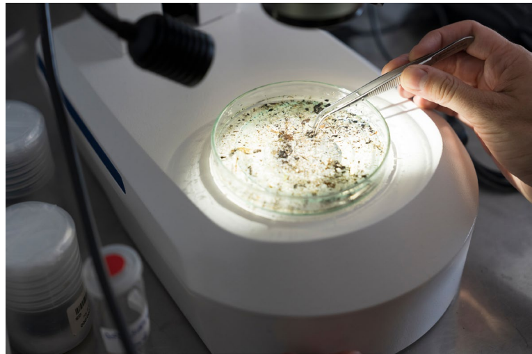
Erst unter dem Mikroskop zeigen sich die verschiedenen Mikroplastikpartikel und können analysiert werden
