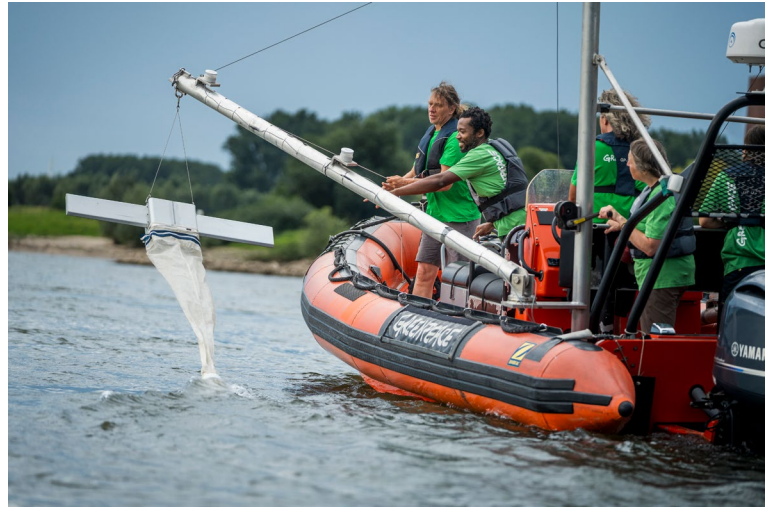
Nach einer zwanzig Minuten langen Messfahrt werden die Manta-Trawls von der Besatzung eingeholt
