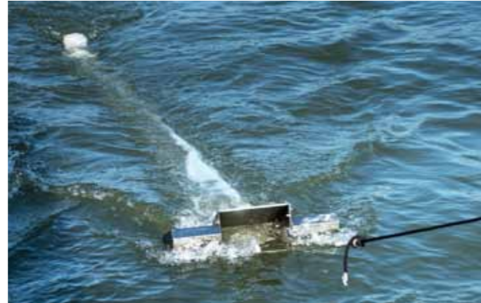
Tragflächen beidseitig des Metallgehäuses halten den Manta-Trawl stabil an der Wasseroberfläche. Mit der Strömung des Rheins wird organisches und anorganisches Material in das Netz geschwemmt und sammelt sich im Netzbehälter an.
