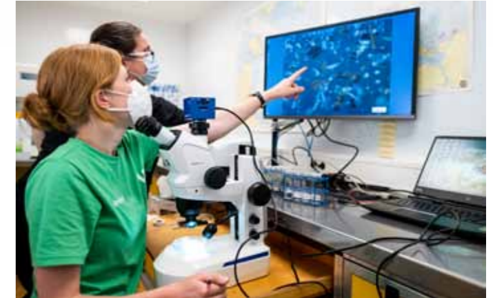
Im bordeigenen Labor lassen sich selbst kleinste Plastikpartikel unter dem Mikroskop erkennen. Mit einem FTIR-Spektrometer werden anschließend die Kunststoffarten bestimmt.
